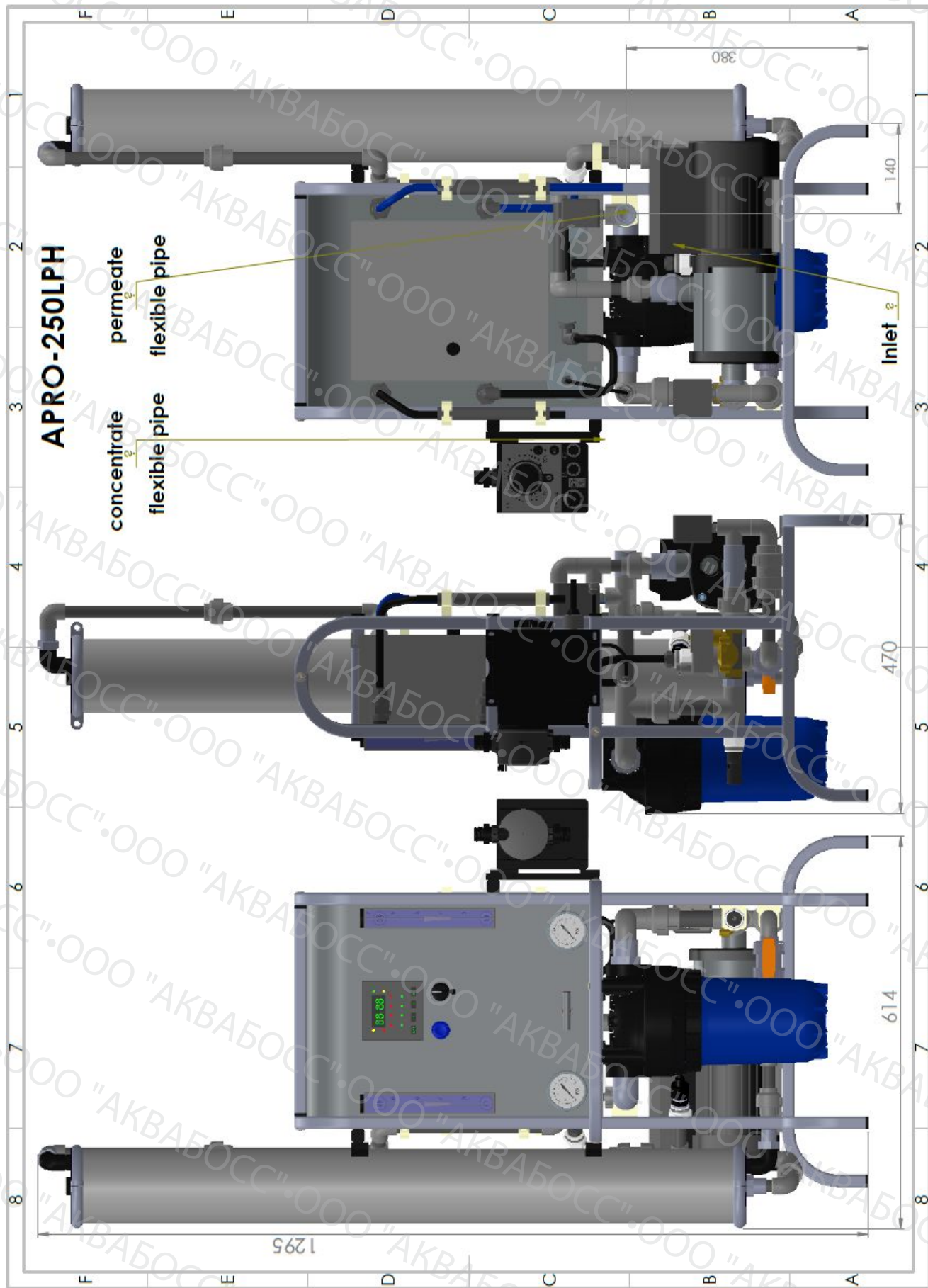
8.7. Габаритные размеры систем обратного осмоса Аквафор моделей АPRO-S-250-22Х
